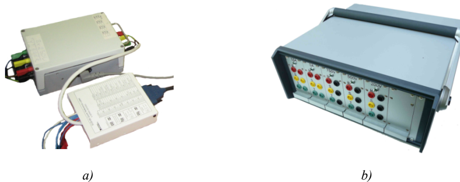
9.2. ábra: Az EET-tanszék „hagyományos” (kisdobozos) kivitelű feszültségváltója (a); és egyedi fejlesztésű, (cserélhető fiókos) áram- és feszültségváltó berendezése (b)
