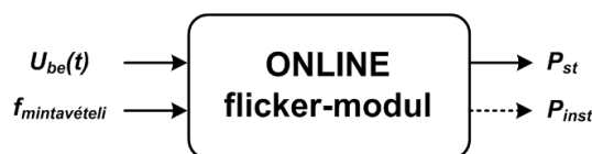
6.1. ábra: Az online villogásmérő-modul interfészei
